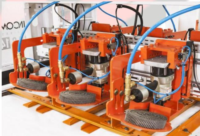
El equipo tiene la finalidad de clavar automáticamente los tacos de madera.
